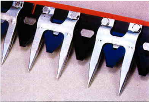
Schumacher knivsystem, enkeltkniv dobbelt slag 570 rpm eller enkelt kniv enkelt slag 650 rpm Rifledede knive, fin eller grov, selvrensede kombineret med stålfigre og styreruller på hele arbejdsbredden
