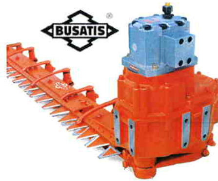
Busatis Bidux dobbeltknive med enkeltslag op til 1000/min. Justerbare føringsarme og trykfjedre. Mekanisk eller hydraulisk transmission op til 5,2m, hydraulisk op til 6,5m. Lukket oliebad drivstation, 2 udvendige arme og forbindelseslejer. 2 udvendige smørepumper interval 8. time.
