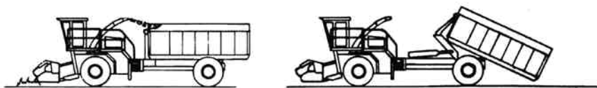
Af- og påsætning op til 35 m 3 container med kran.
