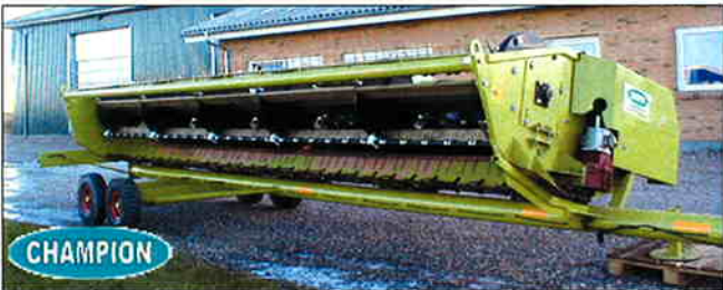
Champion "all crop headers" helsæds/græs borde til direkte høst af grovfo-der afgrøder og special afgrøder.
