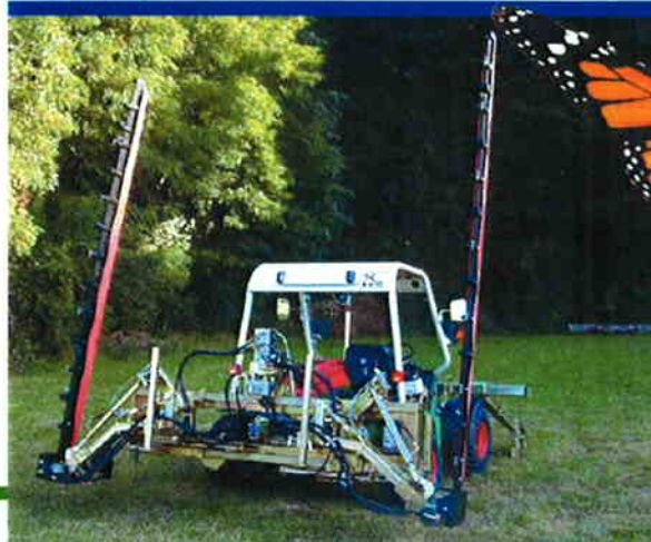
Hydraulisk drevne bagmonterede klippere, udklap til højre og/eller venstre side, med arbejdsbredde op til 2x2,7m.
